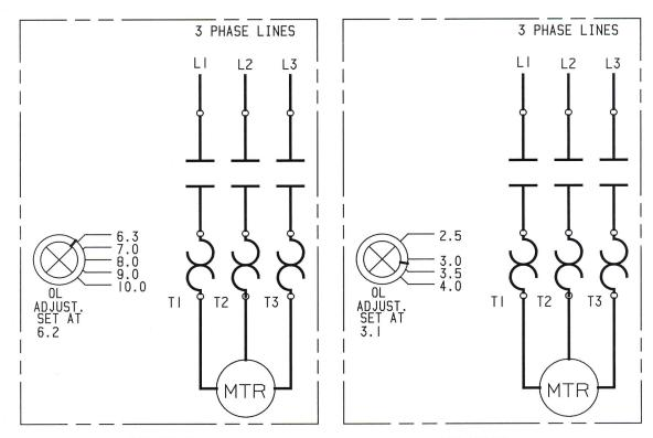
230 VOLTS FOR 2 HP MOTOR DPN IS 75675 FOR 3 HP MOTOR DPN IS 75675 460 VOLTS FOR 2 HP MOTOR DPN IS 75674 FOR 3 HP MOTOR DPN IS 76846
